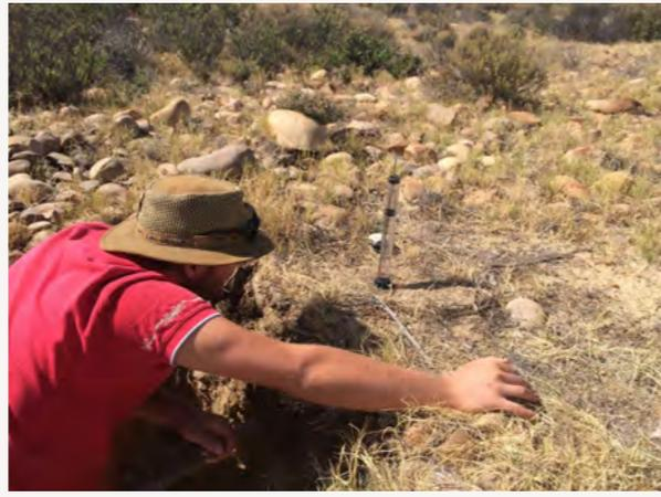
'n Student besig om die waterinfiltrasietempo van 'n grond met behulp van 'n mini-infiltrimeter te bepaal (Foto: Dr JE Hoffman)
