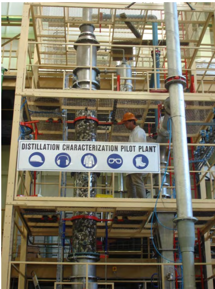
Een van die distillasiekolomme in die Departement Prosesingenieurswese wat voorpunftnavorsing in skeidingstechnologie in die chemiese nywerheid moontlik maak.
