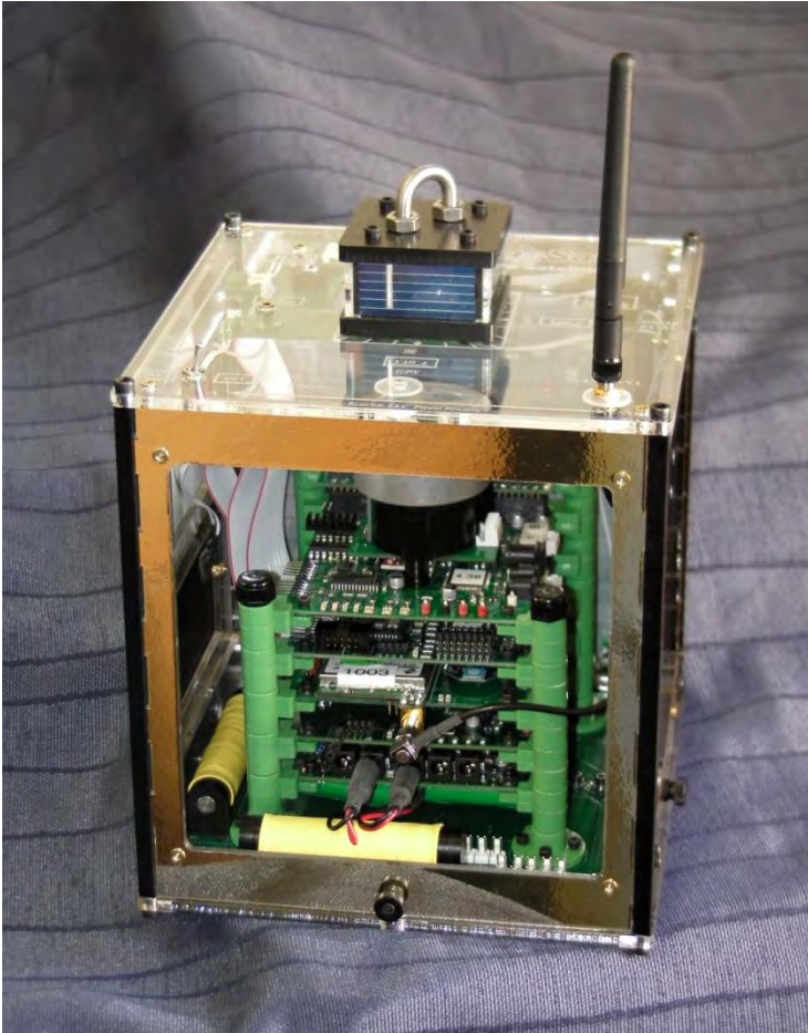
Edu_Satellite is 'n opvoedkundige satelliet wat die Departement Elektriese en Elektroniese Ingenieurswese gebruik in die nagraadse Satellietstelsels-kursuswerk.
