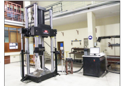
Die universele toetsapparaat met hidrouliese aandrywer het 'n trek- en drukkapasiteit van 2 MN (200 ton).
