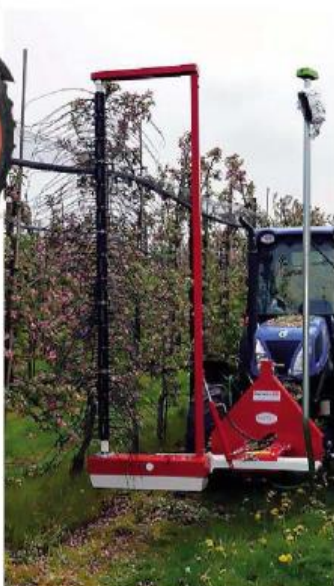
Die blomlading van elke boom kan bepaal word danksy kameras voor op Fruit-Tec se SmaArt Camera System. Daarvolgens word die meganiese uitdunning van elke boom bereken.
