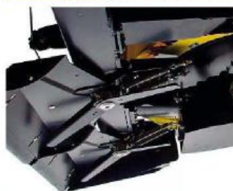
Die Kemper StalkBuster is die eerste stoppel-vernietigende tegnologie wat 'n integrale deel van 'n mieliekuilvoerkop vorm.
