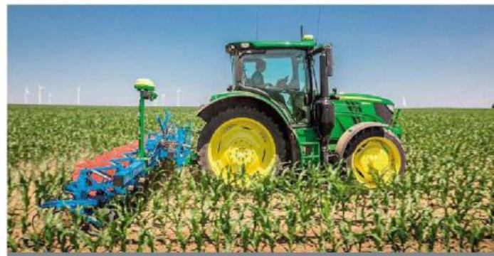
John Deere se presisiestuurstelsel gebruik tweedimensionele kameras om die rye te herken en stuur dan die werktuig deur hidrouliese silinders wat in die plek van die driepuntstabiliseerders aangebring word.
