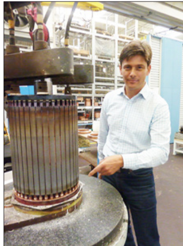
Jacques staan by een van sy gunsteling vervaardigingsprosesse van die trekkrag induksiemotors: Induksiesoldering van die kortsluitring. Die kortsluitring word met behulp van induksieverwarming tot 'n paar honderd grade verwarm.
